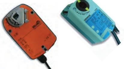
Hava damperlerinin otomasyon sistemiyle kontrol edilmesini sağlayan bu motorlar 24V ve 220V elektrikle çalışır ve hava damperi boyutlarına göre tork değeri seçilerek uygulanır. Klima santrallerinde özellikle karışım hücrelerinde karışım otomasyonunda görev alır. Difüzör hücresinde bulunan hava damperi ise cihaz devre dışı iken cihaz içini dış ortamdan korur.
