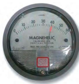
Otomasyon uygulanmayan ürünlerde ise hücre paneli üzerinde gömülü olan fark basınç göstergesinden basınç farkı okunur. Filtre hücresi teknik bilgi etiketinden okunan değere ulaşıldığında filtrelerin değiştirilmesi için Teknofan Teknik Servis hizmetlerini arayınız.
