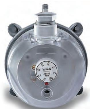
Filtrelerin belirli aralıklarla değiştirilmesi / temizlenmesi gerekmektedir. Fakat değiştirme süreleri sabit bir değere bağlı olmadığından filtrelerdeki doluluk oranını滤re önündeki ve arkasındaki bölgelerin basınç farkından anlayabiliyoruz. Otomasyon sistemine bağlı fark basınç anahtarı filtrenin doluluk basınç kaybı değerine ayarlanır ve tam doluluk anında sisteme uyarı gönderir.
