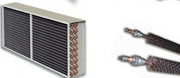
Serpantin alın hızları tüm cihaz tiplerimizde 2-3,2 m/s arası olacak şekilde seçilerek imal edildiğinden serpantinden istenilen en yüksek verimi sağlar. Serpantin malzemesi olarak bakır boru alüminyum kanat veya bakır boru bakır kanat kullanılır. Serpantinler kaplama olarak epoksi veya hidrofilik kaplama işlemeye sokulmuştur. Kollektör çelik veya bakır malzemeden imal edilmiş olup dişli veya flanşlı bağlantı ağızı mevcuttur.
