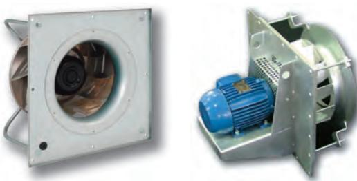
Plug fan uygulamalarında motor mili ara bağlantı olmadan fan göbeğine bağlanır. Motor devri fan devrine eşittir ve frekans invertörü kullanarak hassas devir ayarı ve dolayısıyla debi/basınç ayarı yapılmaktadır.
